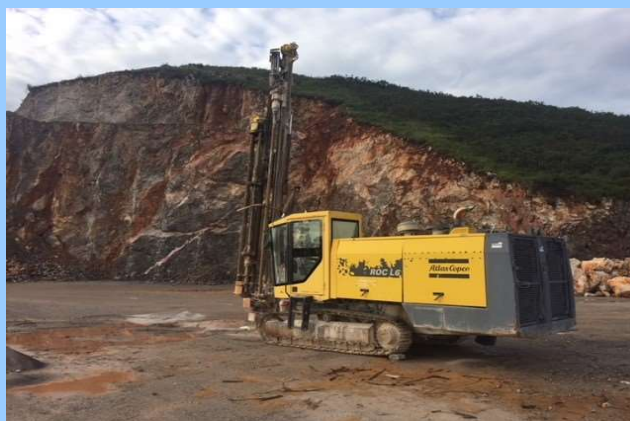
Fotografía 5.7. Captación de Polvo en las Máquinas en la Fase de Perforación
